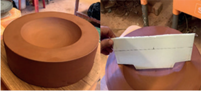
Şekil 9. Merkezlenen çamurun şablon kontrolü ile oyulması (Fot. Füsun Çövenoğlu)
