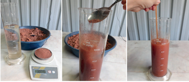
Şekil 26. Kilin tartım ve deflokülanlı yağmur suyu içinde karıştırılması aşaması
