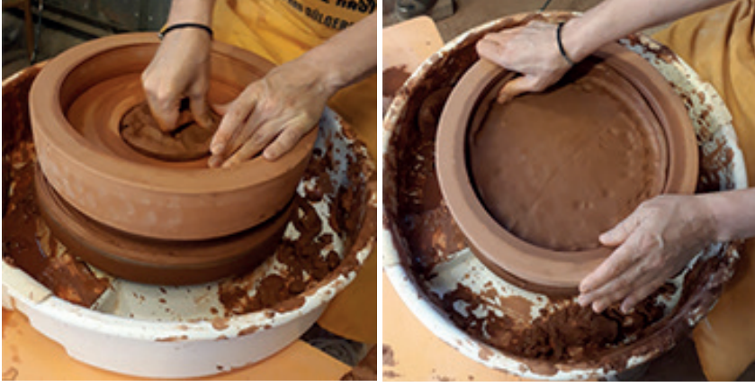
Şekil 12. Seramik kalıba çamur basma işlemi (Fot. Füsun Çövenoğlu)
