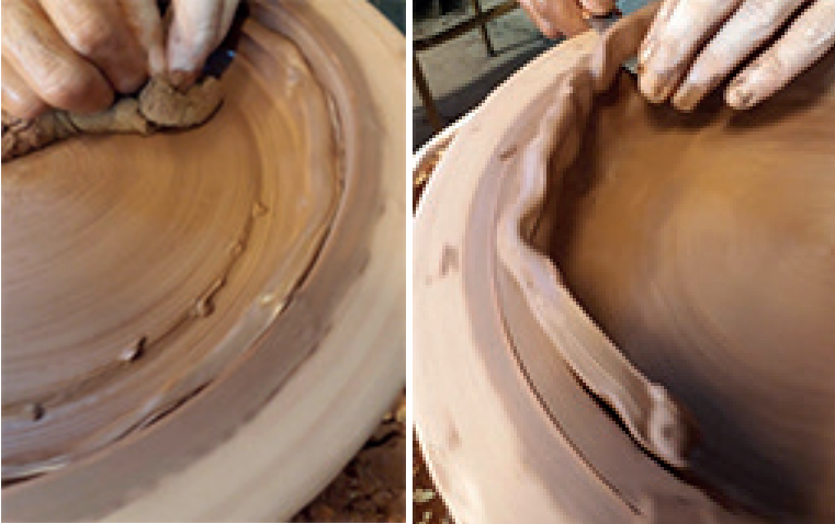
Şekil 13. Kap, çömlekçi çarkında seramik kalıp içine çamur sıkıştırılarak şekillendirilir (Fot. Füsun Çövenoğlu)
